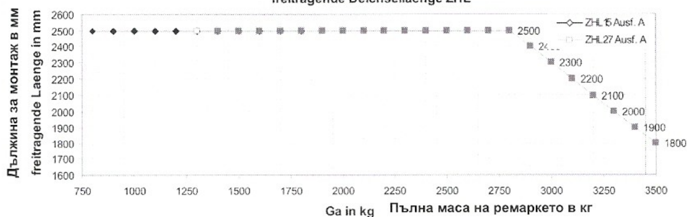
Избиране дължината на теглича ZHL freitragende Deichsellaenge ZHL
